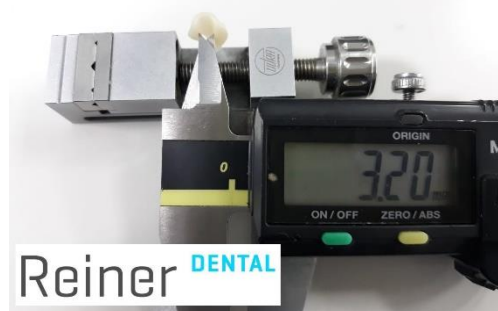
Imagen 3 e Imagen 4. Concordancia entre las dimensiones definidas en el flujo digital CAD y el resultado final de la pieza
